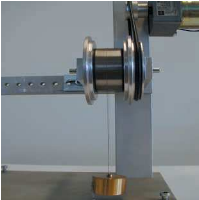
Drallmeßgerät für Wellenoberflächen „Faden-Methode“
