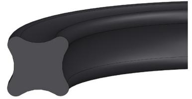
**X-Ringe sind doppelt wirkende Vierlippendichtungen mit einem nahezu quadratischen Querschnittsprofil. DICHTOMATIK bietet X-Ringe aus NBR und FKM ab Lager. Die Verarbeitung weiterer Werkstoffe, wie beispielsweise VMQ, EPDM und HNBR, ist auf Anfrage möglich.**
