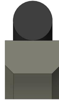
Die doppelwirkende SPOR30 besteht aus einem PTFE Bronze-Dichtelement und einem O-Ring, der als Vorspannelement dient.
